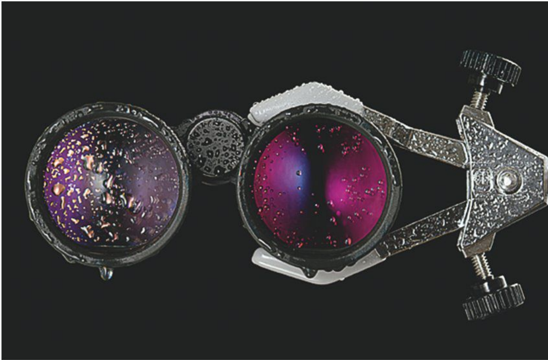
Sulla lente destra, l'effetto del trattamento antisporco che impedisce alle gocce d'acqua di aderire. Lo stesso trattamento conferisce maggiore resistenza ai graffi.
