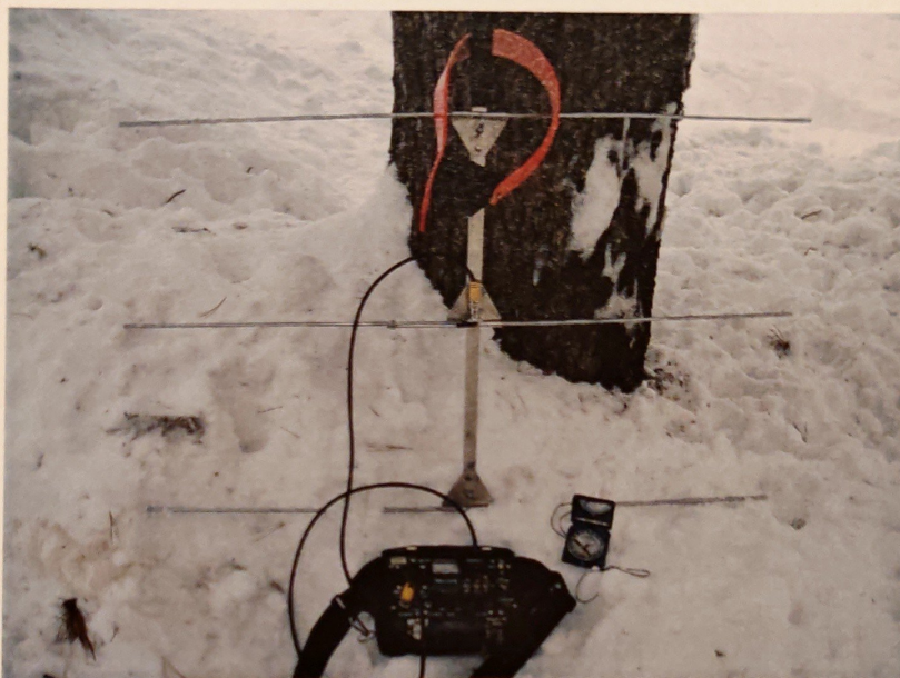
fig 6: attrezzatura. radiocollare, antenna Yagi, bussola e radio ricevente
